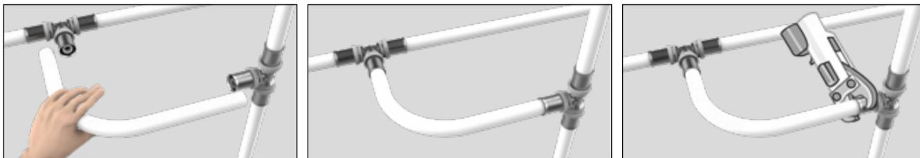
Tout cintrage sur un tube déjà assemblé risque de créer de graves désordres, notamment au niveau des raccords. Les tubes FLUXO® doivent donc être cintrés avant d'être sertis.
